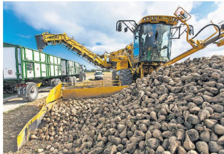
Eine Rübenreinigungslademaschine – genannt «Maus» – ist ebenfalls im Einsatz.
